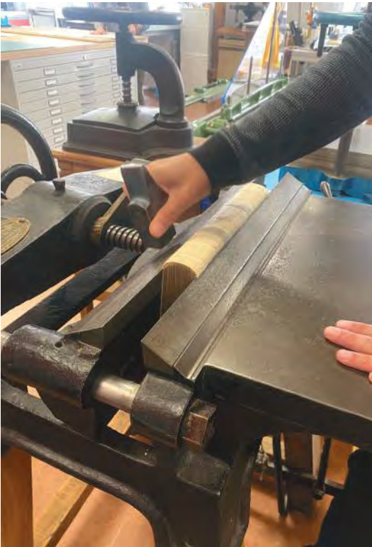
Préparation du corps d'ouvrage avant la couverture à l'atelier de reliure et de restauration, INHA, 2024. © Julien Brault, INHA, 2024.
